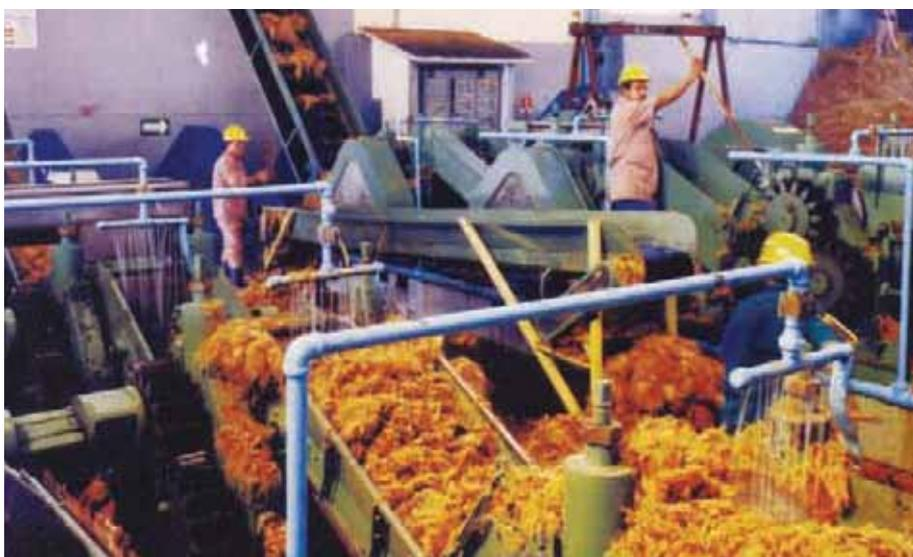
25 Molino mecánico para la extracción del "mosto"
